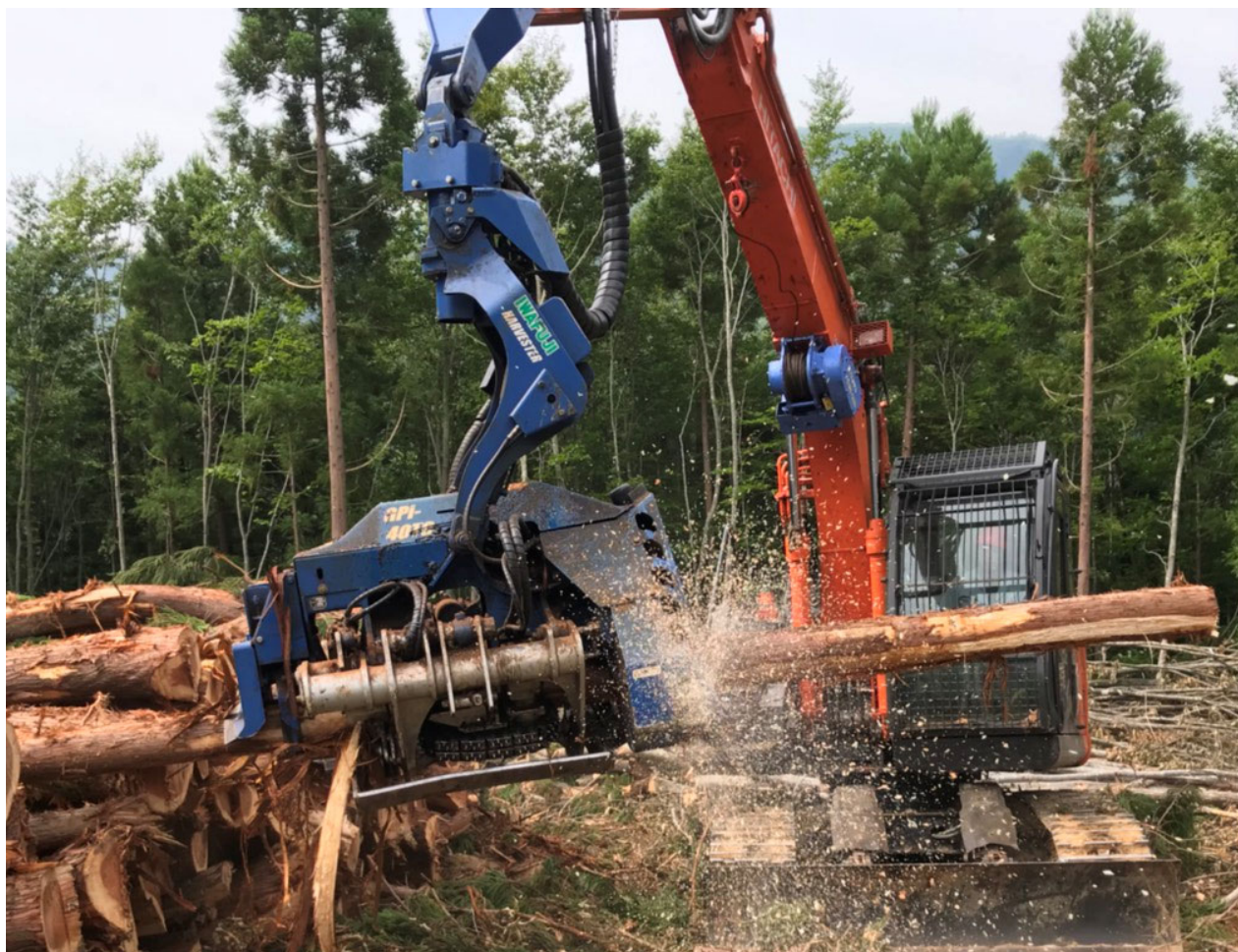
高性能林業機械(ハーベスタ)による造材作業
