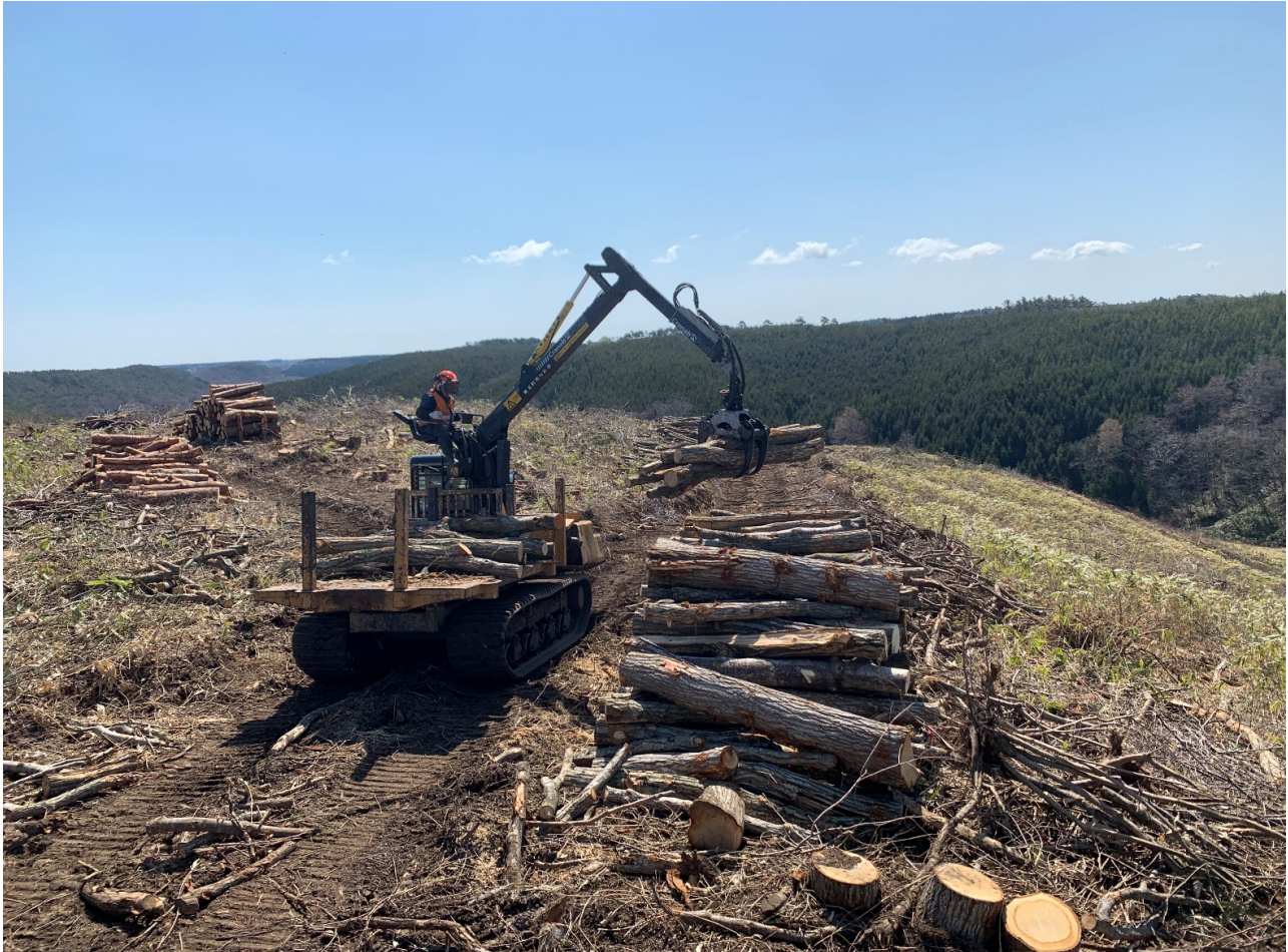
高性能林業機械(フォワーダ)による運材作業
