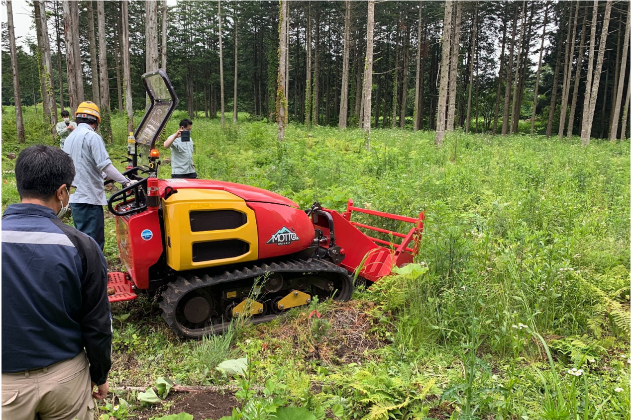
新規導入した高性能林業機械(自走式下刈機械)
